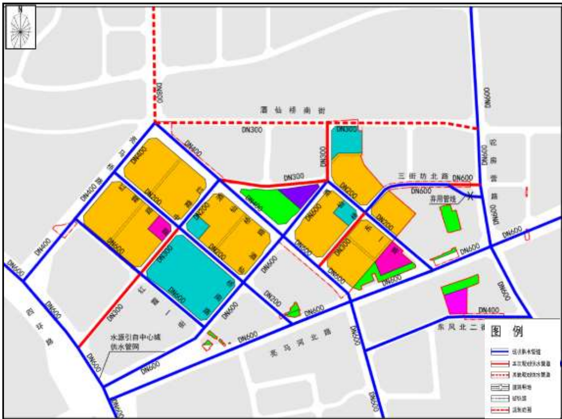
图 2-4 地块所在区域供水管线规划示意图
