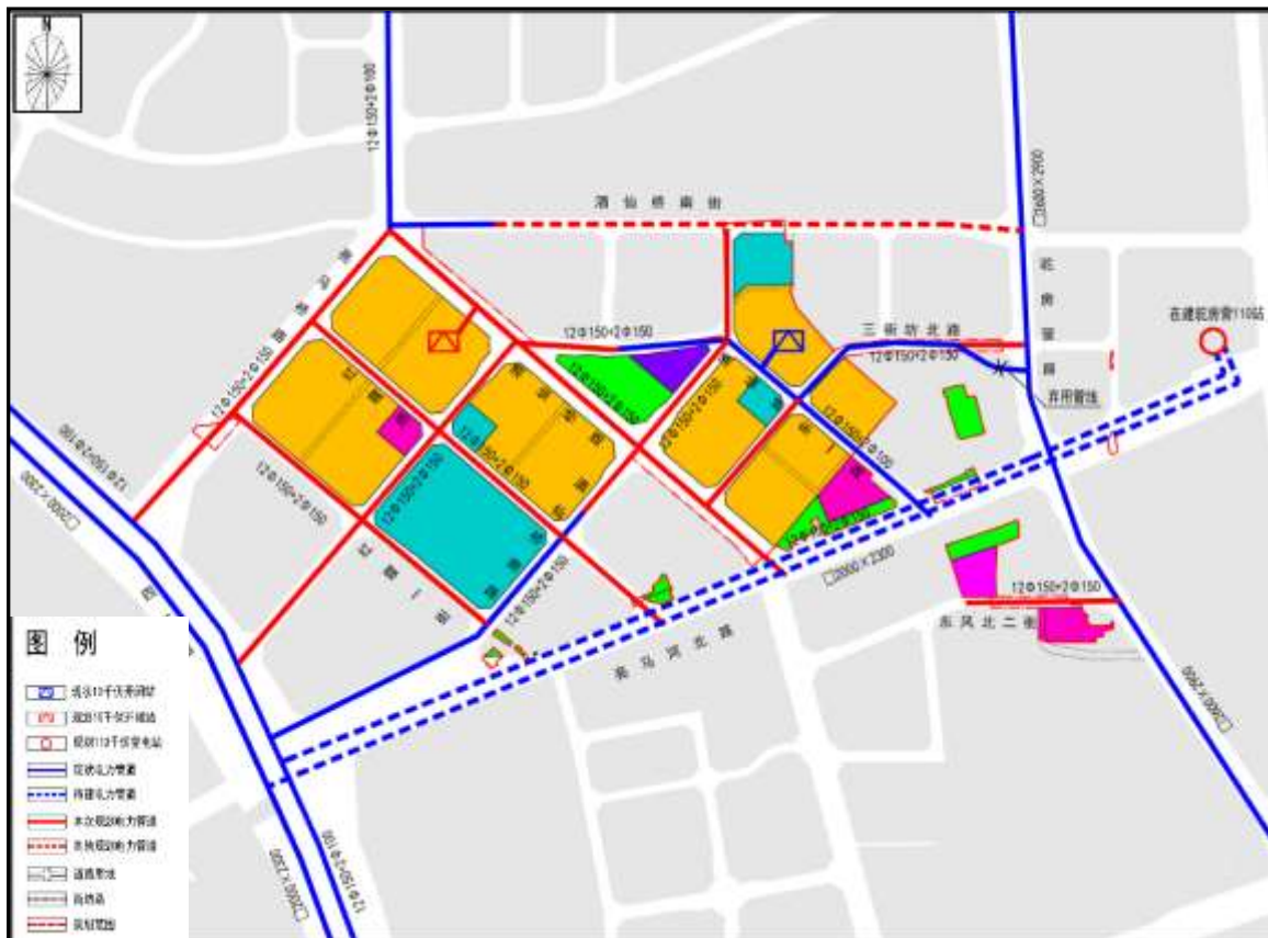
图 2-9 地块所在区域供电管线规划示意图
